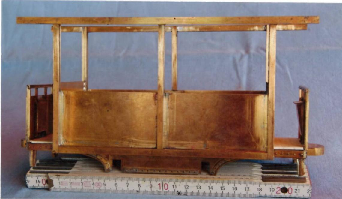
Le « squelette » de la caisse est constitué de plaques de laiton de 0,5 mm d'épaisseur, prises en sandwich entre des profils laiton de 5 x 2 mm. L'habillage en plasticard Evergreen de 1,5 mm d'épaisseur est collé à la cyanolite sur le laiton. Les moulures sont faites en profilés de la même marque de 1 x 1 mm. Les banquettes sont aussi en plasticard rainuré.
