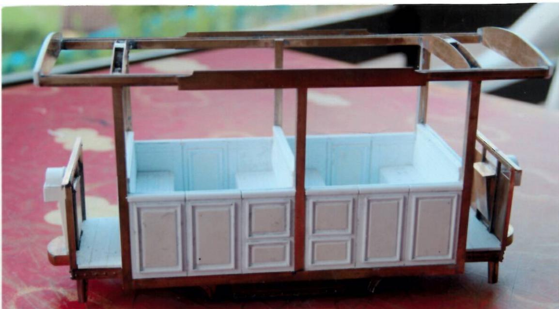
Le toit est en cuivre de 0,5 mm d'épaisseur fixée par deux vis dans l'axe des parois frontales intérieures. Il est doublé en plasticard de 1 mm rainuré pour simuler les planches.
